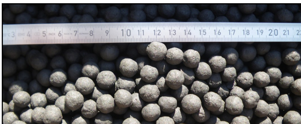
Abbildung 1.2: Darstellung von Eisenoxidkugeln, die im Pelletierverfahren hergestellt wurden
